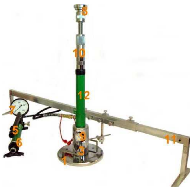
Rys. 1.2 Aparatura VSS z jednopunktowym pomiarem przemieszczenia płyty
